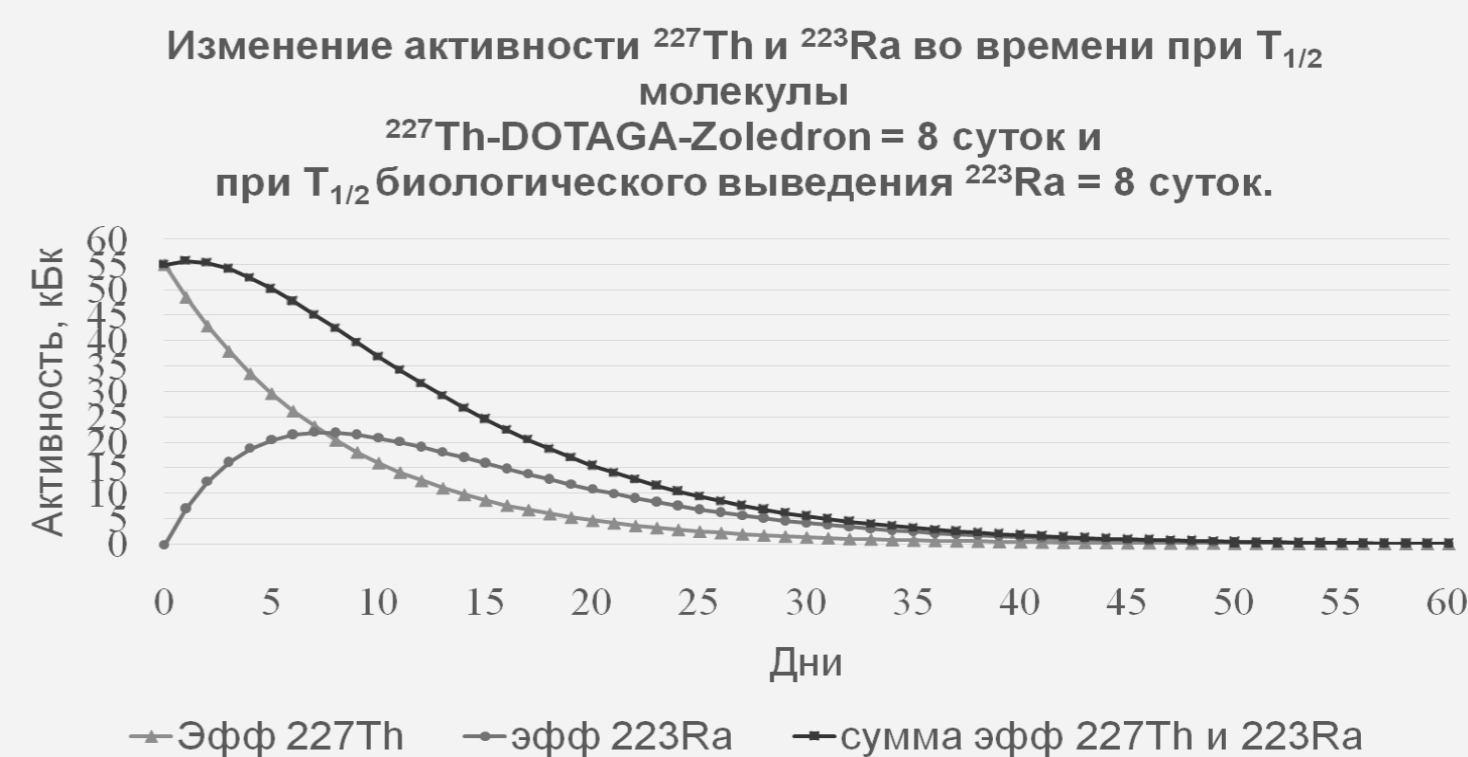
Рис. 2 Изменение активности ^{227}\text{Th} и ^{223}\text{Ra} во времени при предположительном теоретическом биологическом периоде полувыведения = 8 суток ( A_0^{227}\text{Th-DOTAGA-Zoledron} = 55 кБк).
